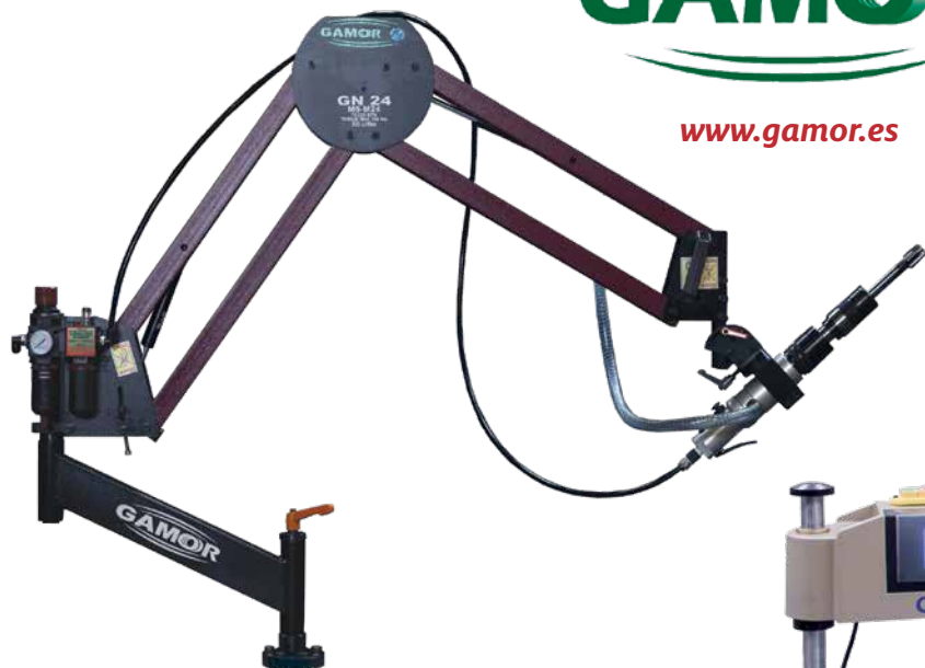
Gamor kierteityskone hydraulisena, paineilma- ja sähkökäyttöisenä. Kierteet M2-M130 saakka.
